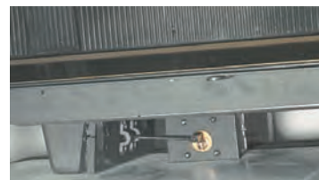
Détail de l'embase du 851 CH AUTO électronique avec vue du moteur électrique actionnant le clapet d'arrivée d'air frais.
